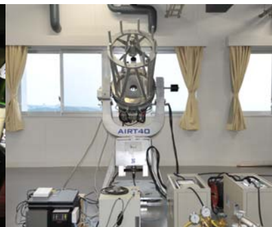
最終的に組み上がった状態の南極40cm赤外線望遠鏡。手前に見える箱は制御装置。
