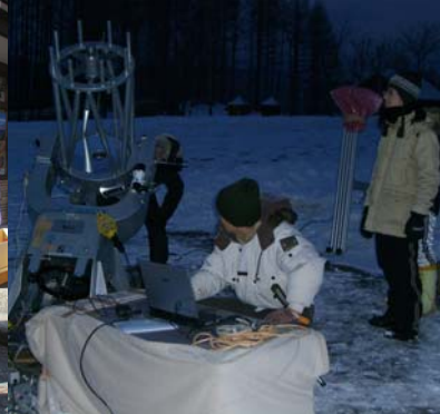
北海道陸別町で実施した望遠鏡の寒冷地 実験。実験室では分からなかった事を多く 発見できた。
