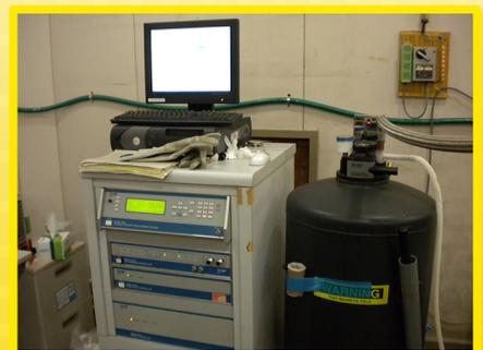
↑物理特性測定システム。温度 0.4K、磁場 7 テスラで測定可能
