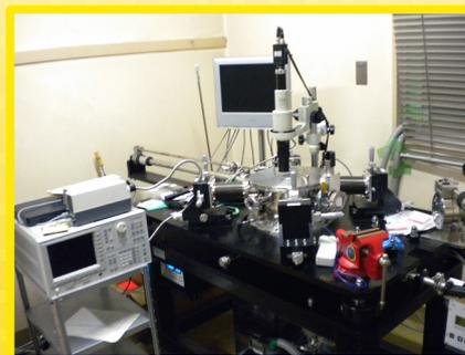
↑電気特性評価のための低温プローブと半導体パラメータアナライザ
