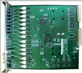
Trigger Logic FPGA: Spartan 3E x 1 Trigger System FPGA: Spartan 3E x 1
